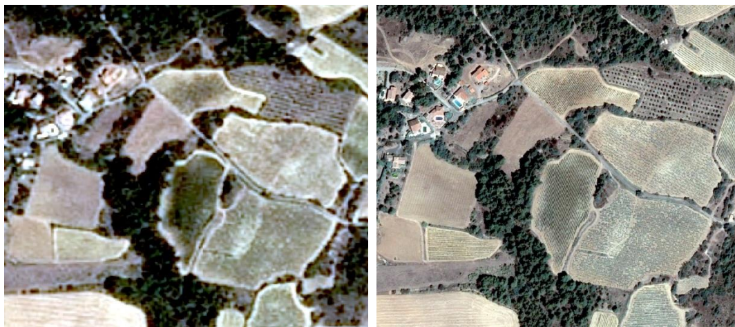
Figure 7: Extraits d'images satellites sur une zone viticole du Minervois : image du satellite SPOT 7 du 28/07/2016 (à gauche) d'une résolution spatiale de 1.5m et image du satellite Pléiades du 25/08/2016 (à droite) d'une résolution de 70cm. © AIRBUS Defence & Space.
