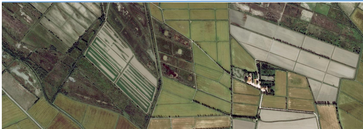
Figure 9: Extrait d'image numérique satellite avec composition colorée associant 3 bandes spectrales
